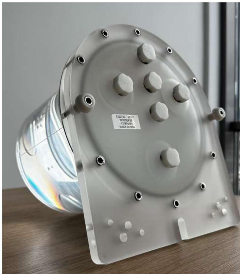
**Рисунок 2.** NEMA Phantom for GE (однородный фантом, наполненный чистой водой и активностью изотопа  $^{18}\text{F}$  - FDG)
