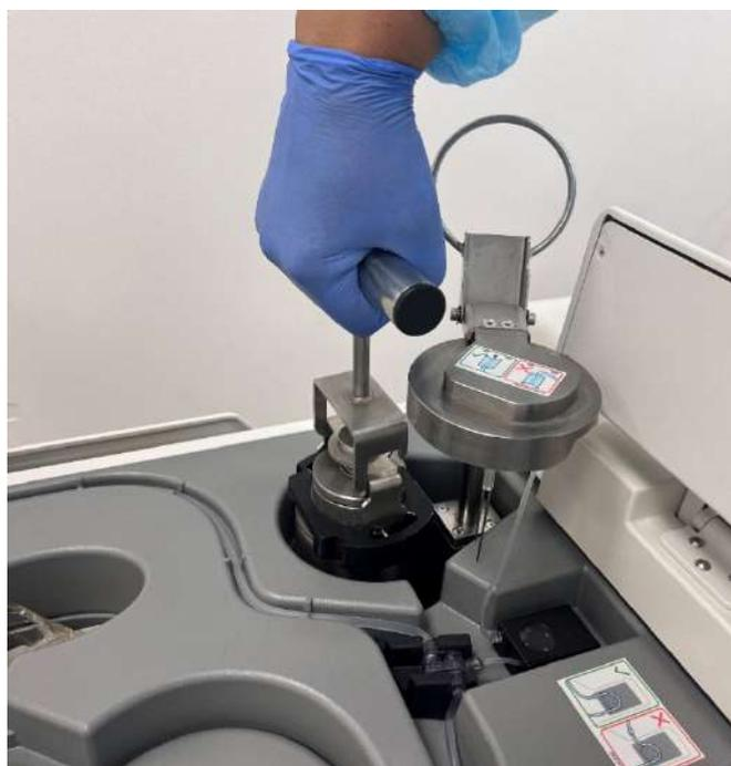
Рисунок 2. Защитный экран емкости
