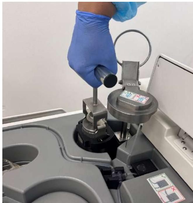
Рисунок 2. Защитный экран емкости
