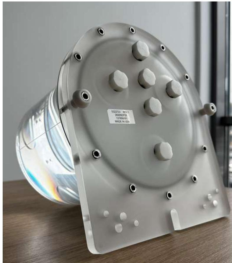
**Рисунок 2.** NEMA Phantom for GE (однородный фантом, наполненный чистой водой и активностью изотопа 18F - FDG)
